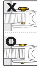
PRESIONE HACIA ABAJO el tensor de cinta para fijar la posición de la cinta.
