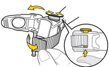
Abra la palanca de bloqueo y levante y afloje el tensor de cinta.
